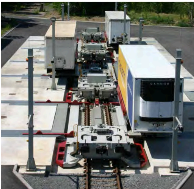
Figura 12: Foto: Sistemul Cargo-Beamer din Koeln 21
